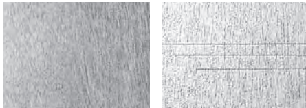
ワンラブフロア 表面の凹みが目立ちにくい。 ※耐傷性試験には他の床材を使用しておりますが、表面性能は同じになります。 一般カラーフローア 表面の凹みがよく目立つ。
