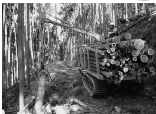
作業路からの高性能林業機械による集材作業
